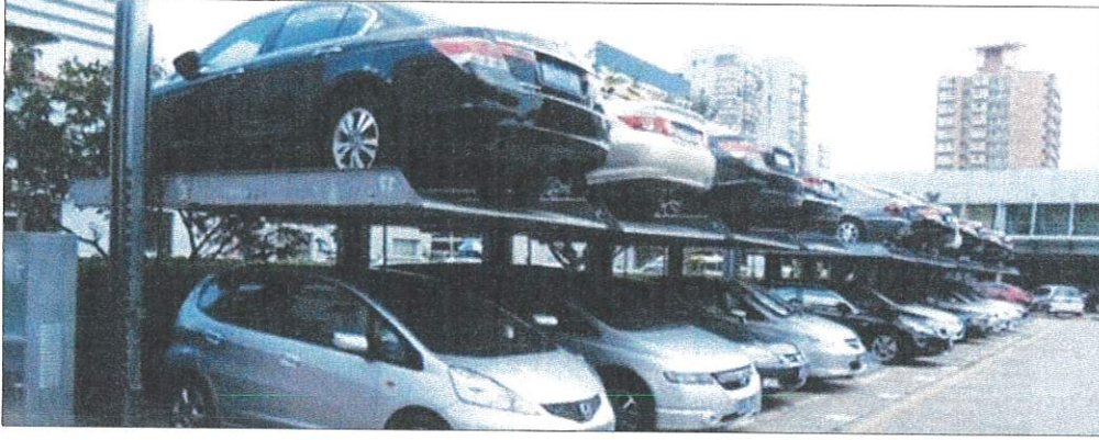
Resim 6.1: Normal otoparklar için örnek mekanik otopark sistemi
